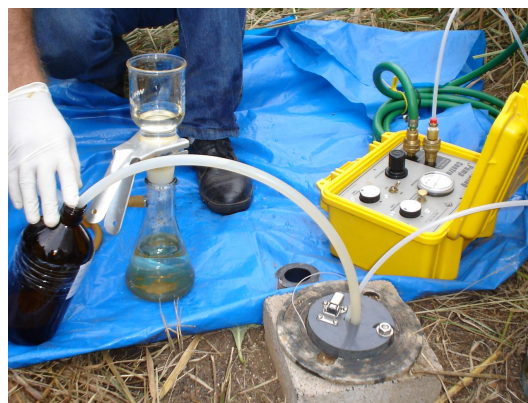
Foto 17 – Amostragem para análise de TPH
