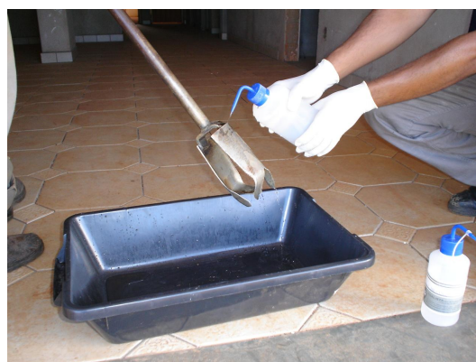
Foto 21 – Esterilização do equipamento de sondagem
