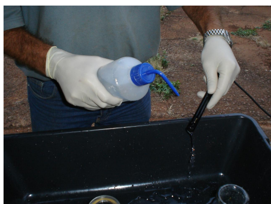
Foto 20 – Circulação de acetona e hexano
