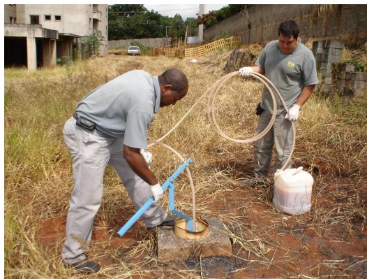
Foto 09 – Efluente da purga direcionado ao recipiente para cálculo do volume
