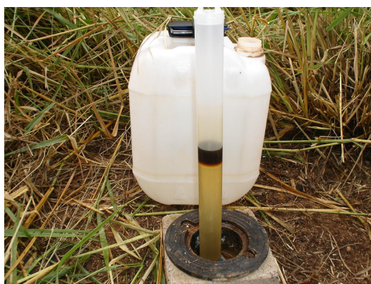
Foto 10 – Fase livre identificada em monitoramento do PM-02
