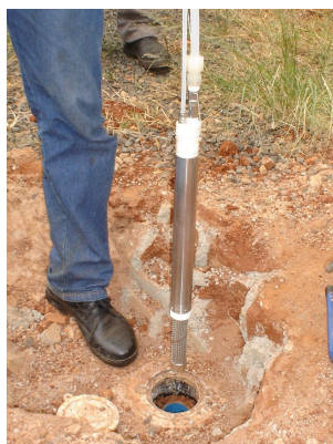
Foto 13 – Detalhe da bomba de bexiga
