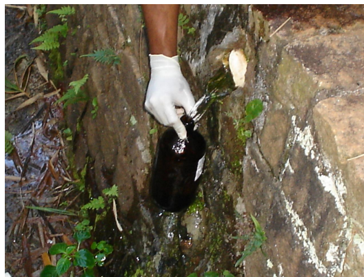
Foto 23 – Amostragem direta da água da nascente para análise de fenóis
