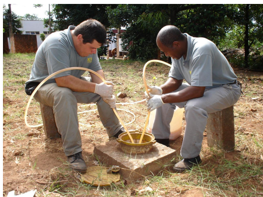
Foto 07 – Purga manual dos poços
