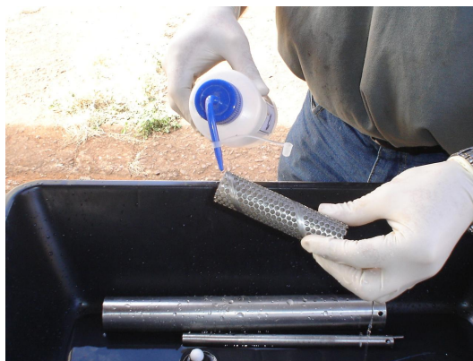
Foto 19 – Circulação de água deionizada em peça da bomba de bexiga
