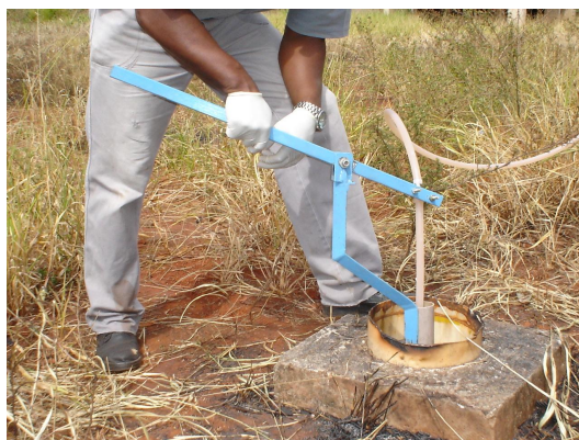
Foto 08 – Purga dos poços com auxílio de dispositivo
